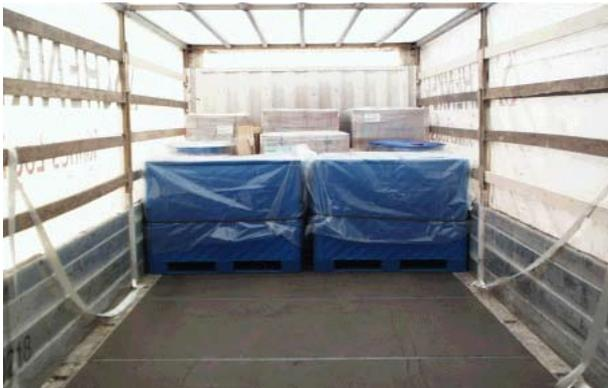
Stau- bzw. Sicherungsschritte sind zum einen das formschlüssige Verladen der Paletten sowie das Ausfüllen der freien Stauräume, zwischen der Fassware, mittels Paletten oder Ladungssicherungsrahmen.
