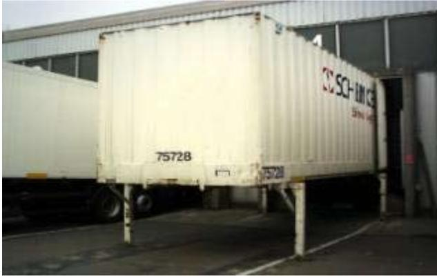
Transportgefäß ist eine Wechselbrücke
