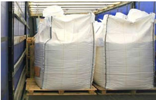
Die weiteren Paletten werden bündig an die Paletten der ersten Blockbildung angesetzt
