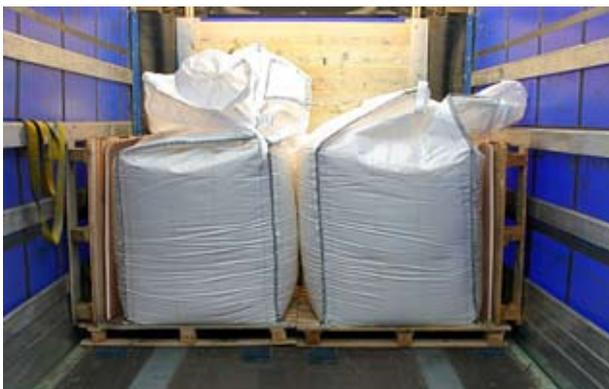
Die BigBags auf Palette wurden bündig an die Stirnwand vorne gesetzt. Gleitreibbeiwert zwischen BigBag und der Palette sowie Palette und dem Fahrzeugboden müssen gleich sein.
