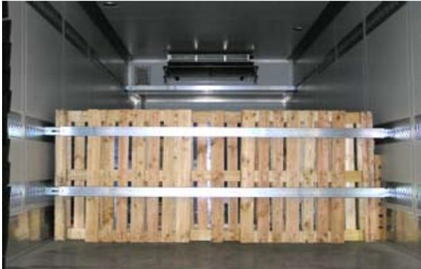
Verladung auf eine Wechselbrücke, hier gesichert mit Sperrbalken und Paletten.
