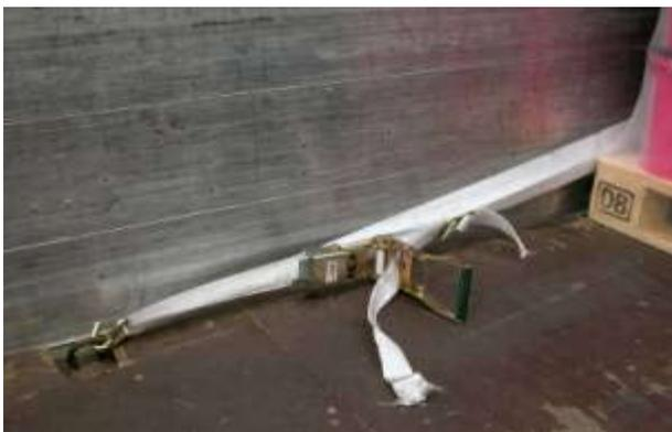
Nachdem die ersten Paletten des zweiten Blockes gestaut wurden, wird der weiße Gurt gespannt. Die Sicherung nach vorne ist damit abgeschlossen.
