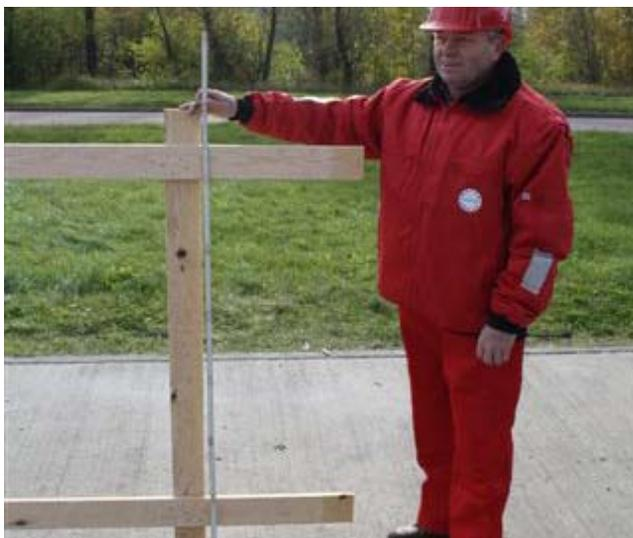
Symmetrischer Holzrahmen verhindert das Abrutschen des gespannten Stahltexbandes und der Gurte.
