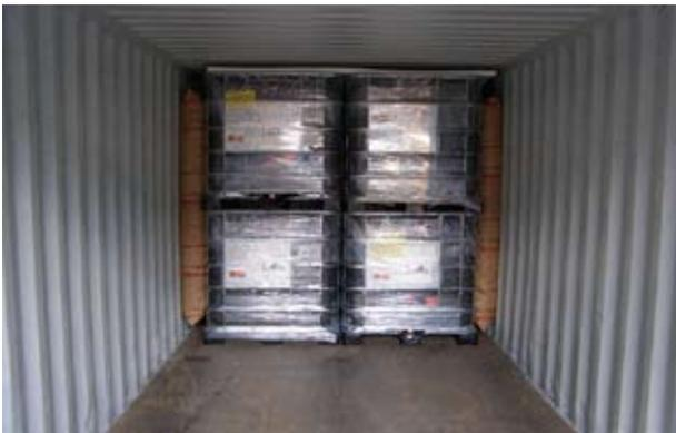
Die ersten vier IBC werden mittig (wegen der oberen Eckbeschläge) gegen die Stirnwand geladen und der seitliche Freiraum wird mit Luftpolstern ausgefüllt
