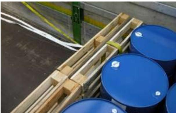
Der zweite Block wird vorbereitet. Hierfür wird ein Gurt (gelb) zur Sicherung der Ladung nach hinten benötigt. Der weiße Gurt wird für die Sicherung nach vorne eingesetzt. Es handelt sich hierbei um einen Einweggurt (2500 daN), der doppelt von dem linken zum rechten Zurrpunkt gelegt wird. Die Paletten dienen hier zur Sicherung gegen das Herabfallen des weißen Gurtes.
