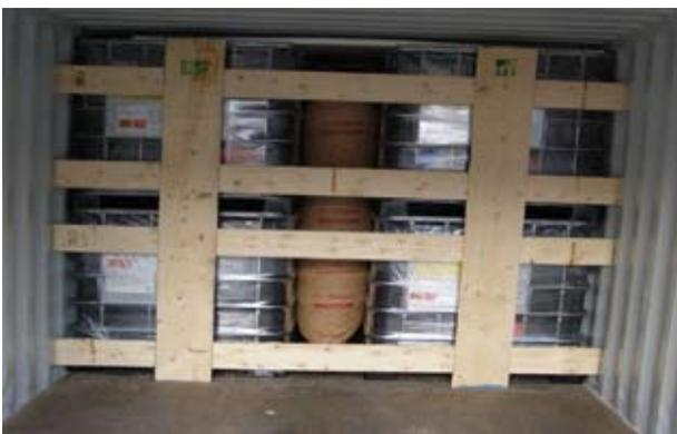
Die nächsten vier IBC werden davor geladen; jedoch stehen sie an der Seitenwand an. Es bildet sich ein Freiraum in der Mitte, der wiederum mit Luftpolstern ausgefüllt wird. Danach wird ein Zwischengatter aus vier waagerechten und zwei senkrechten Dielen angebracht.
