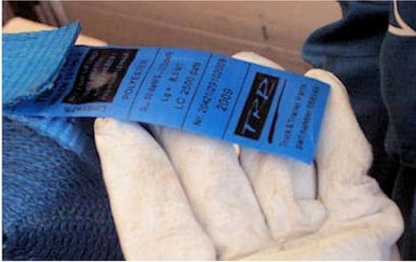
Zustand und Art des Spanngurtes (ggf. anhand der Herstellerkennzeichnung) überprüfen.
