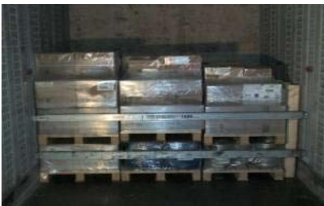
Stau- bzw. Sicherungsschritte sind zum einen das formschlüssige Verladen der Paletten sowie das Ausfüllen der freien Stauräume mit Paletten oder Ladungssicherungsrahmen und das Zwischensichern mit Tragbalken.
