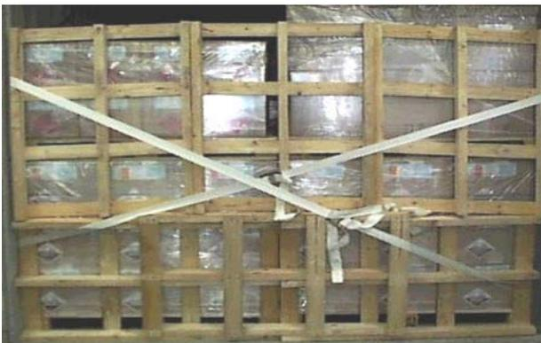
Der freie Stauraum wird mit Ladungssicherungsrahmen ausgefüllt. Die Ladung wird durch das diagonale Verzurren mittels Spanngurten gesichert.
