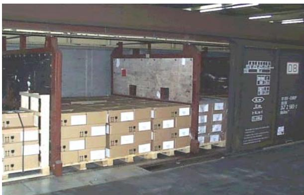
Der Stauraum wird mittels Sicherungstrennwänden gleichmäßig in Kammern eingeteilt. Innerhalb einer Kammer werden freie Stauräume mit Ladungssicherungsrahmen ausgefüllt.
