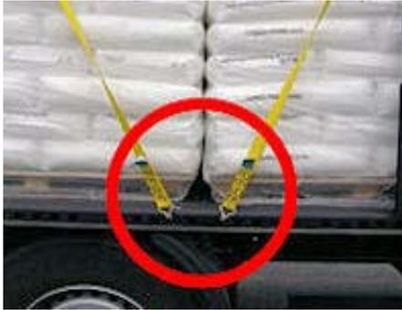
Die Spanngurte sind nach Möglichkeit immer an der von der Umlenkung gegenüberliegenden Palettenseite am Fahrzeug zu fixieren (optimal: Fahrzeug mit Lochrahmen).
