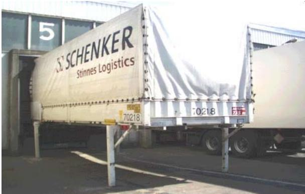
Transportgefäß ist eine Wechselbrücke.
