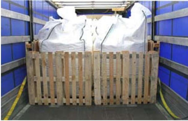
Erste Blockbildung für die Sicherung der Ladung in Längsrichtung nach vorne
