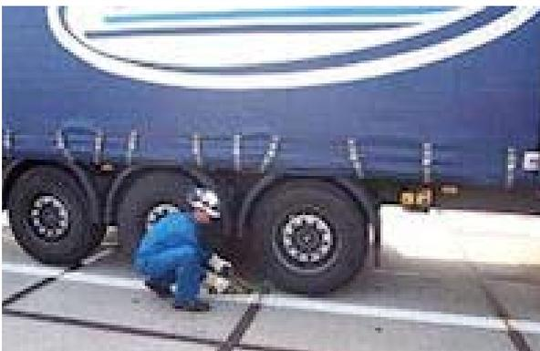
Der LKW ist gegen Wegrollen zu sichern. Dieses kann in unterschiedlicher Weise erfolgen, z.B. durch Unterlegkeil oder Fixierung des Fahrzeugs an der Ladebrücke.
