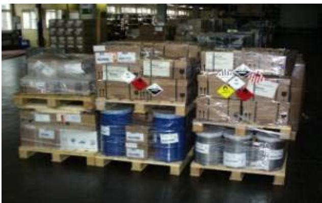
Das Ladegut besteht aus Ladeeinheiten mit Kartons und Fässern.
