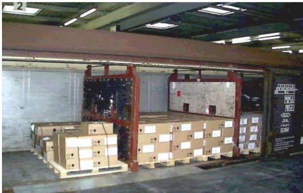
Stau- bzw. Sicherungsschritte sind das form-schlüssige Verladen der Paletten und gleich-mäßige Einbringen der Sicherungstrennwände.
