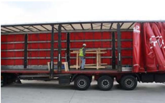
Fahrer ordnet Ladungssicherungs- material und legt 4 ARM für den ersten Octabin in Position;
