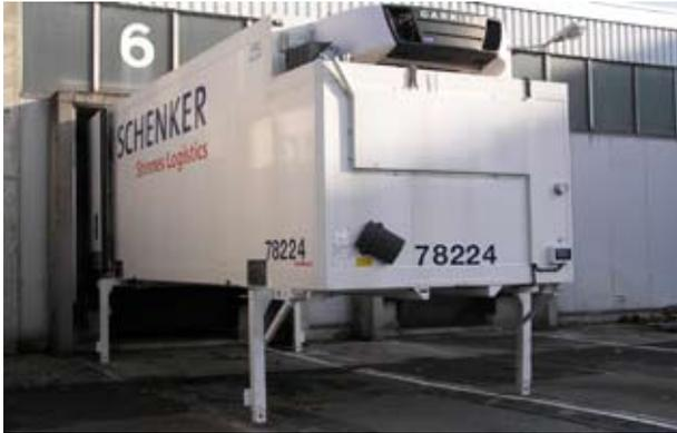
Transportgefäß ist eine Wechselbrücke.
