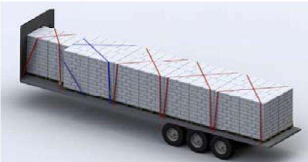
Schematische Darstellung einer Komplettladung bestehend aus 18 Paletten und der entsprechenden Anzahl der Gurte.
