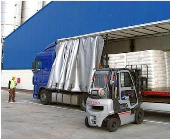
Aus Gründen der Arbeitssicherheit sollte sich der Fahrer an einem sicheren Ort aufhalten, insbesondere um Unfälle mit Gabelstaplern zu vermeiden. Je nach standortspezifischen Sicherheitsregeln wird dieses unterschiedlich gehandhabt.
