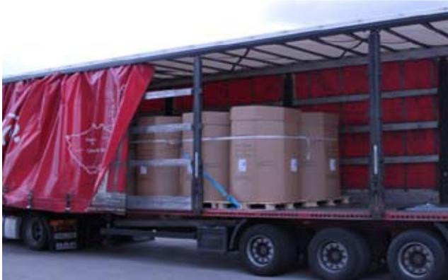
4 Octabins werden zur Sicherung gegen das Umkippen mit Stahltextband zu einem Block zusammengefasst.
