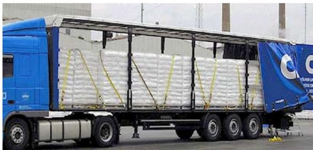
Nach der Beladung sind die Gurte anzulegen und auf konkreten Sitz zu kontrollieren. Dieses ist sicher vom Boden aus oder mit Hilfe einer sicheren Leiter durchzuführen. Niemals auf der Ladung herumklettern!
