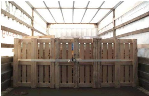
Der freie Stauraum wird mit Paletten ausgefüllt. Die Ladung wird durch das horizontale Verzurren gesichert.
