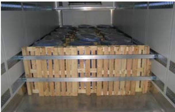
Der freie Stauraum wird mit Paletten ausgefüllt, damit die Ladung ihre Position zu sich und den Bordwänden des Transportgefäßes nur geringfügig verändern kann. Die Ladung wird durch das Justieren der Tragbalken gesichert.
