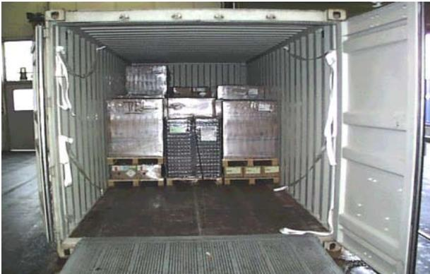
Stau- bzw. Sicherungsschritte sind zum einen das formschlüssige Verladen der Paletten und zum anderen das Anbringen der Ladungssicherungsbinden an den Seiten.
