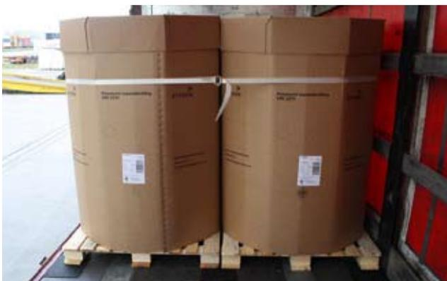
4 Octabins werden zur Sicherung gegen das Umkippen mit Stahltextband zu einem Block zusammengefaßt.
