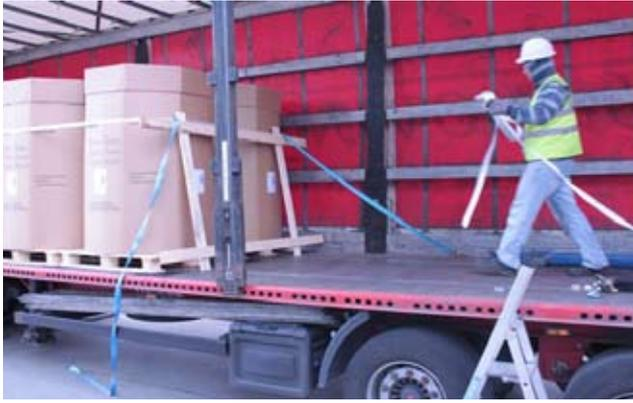
Fahrer stellt Holzgatter in Position, legt Stahltextband und Gurt um das Gatter und legt ARM aus.
