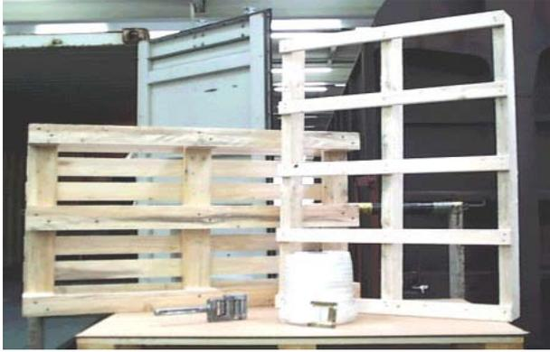
Als Sicherungsmaterial kommen Palette, Ladungssicherungsrahmen, Pressspanplatten, Ladungssicherungsband, Stahlschnallen und ein Handspanngerät zum Einsatz.
