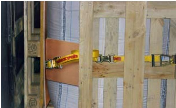
Verbindung der Zurrgurte mittels Zurrhaken
