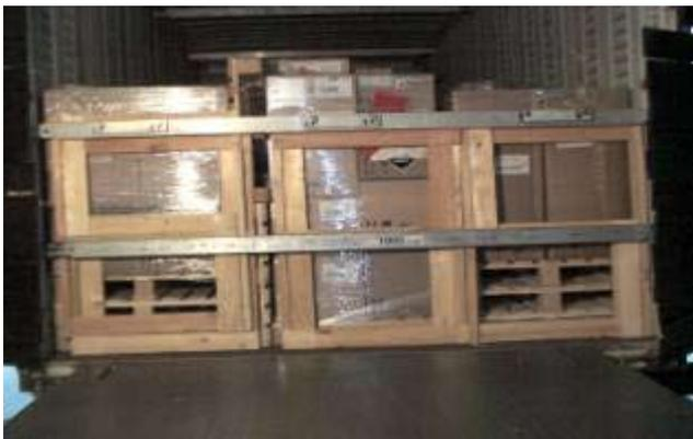
Der freie Stauraum wird mit Paletten ausgefüllt. Die Ladung wird durch das Justieren der Tragbalken gesichert.
