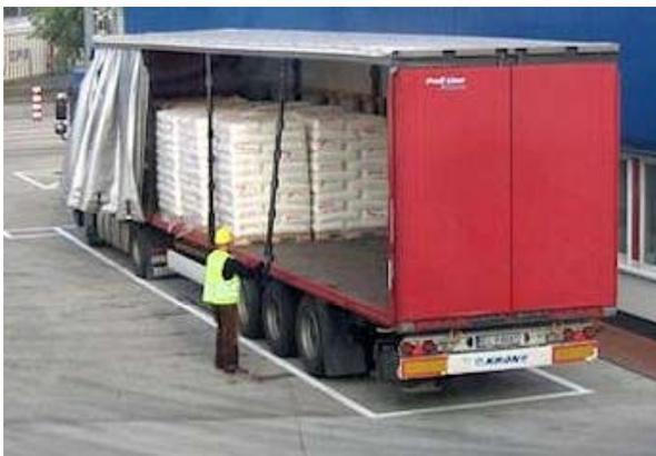
Das Anlegen der Spanngurte erfolgt während der Beladung. Dabei muss sich der Gabelstapler in sicherer Entfernung zum Fahrer befinden.
