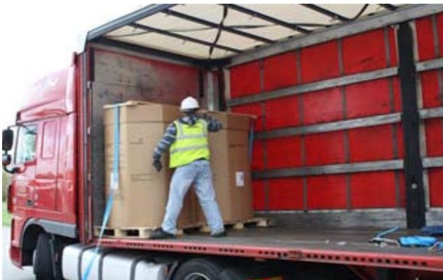
Octabinreihe wird zur Sicherung gegen das seitliche Umkippen niedergezurrt.
