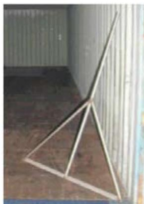
Abbildung 46 Metallschieber zur Bodenkontrolle
