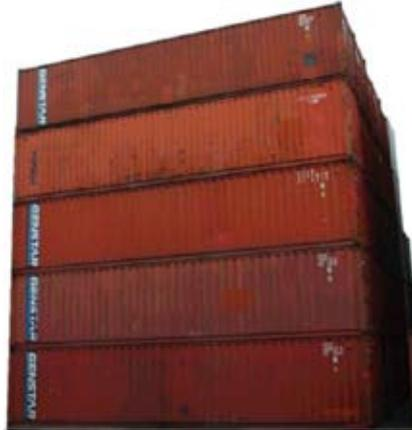
Abbildung 23 Stapelung (Ein Container muss 5 vollbeladenen Container tragen)
