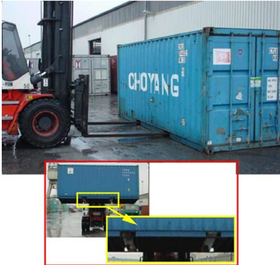
Abbildung 20 Standard-Stückgut-Container mit Gabelstaplerlaschen
