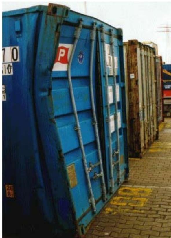
Abbildung 40 Stark beschädigter Containerrahmen
