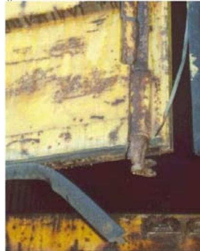
Abbildung 43 Defekte Türdichtung
