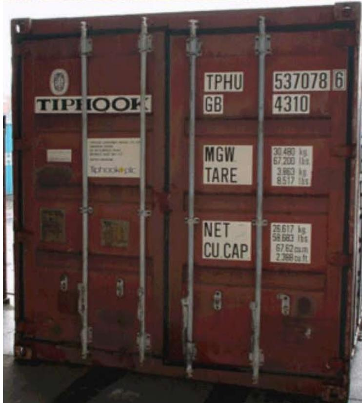
Abbildung 24 Containerkennzeichnung im Detail 1
