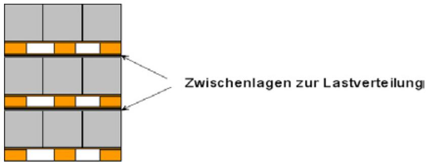
Abbildung 31 Druckfeste, standsichere Oberfläche zum Stapeln
