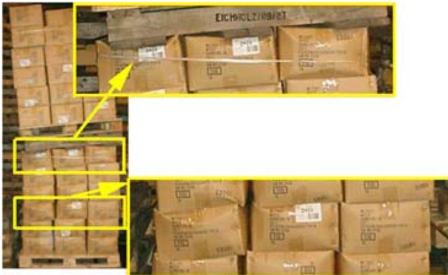
Abbildung 30 Beschädigung des Ladeguts durch Stapelung
