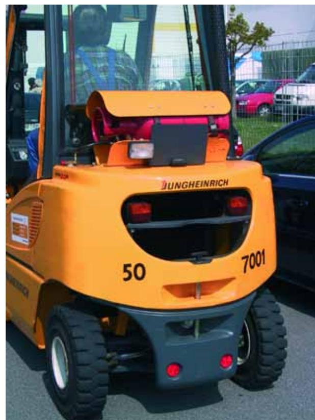
Abb. 3: Schlussleuchten, Bremsleuchten, Rückstrahler und Fahrrichtungsanzeiger
