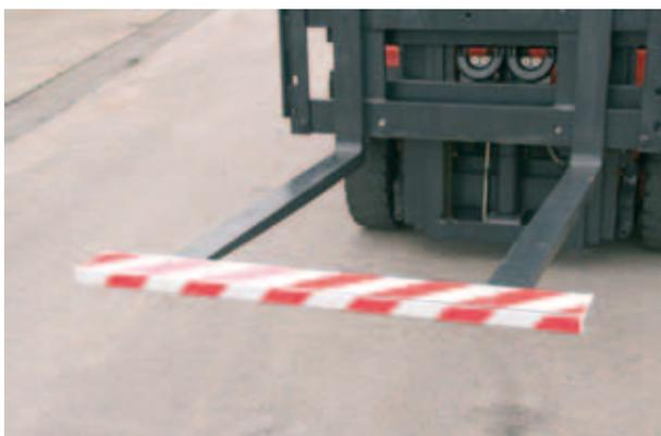
Abb. 2: Schutzvorrichtung zum Abdecken der Gabelspitzen
